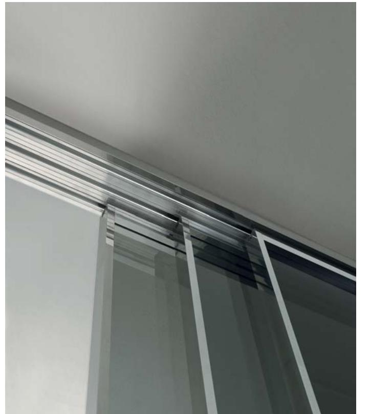
Slide nelle versioni con binario a tre vie esterno ed incassato nel controsoffitto. La versione con il binario incassato si compone di un profilo da installare durante la posa del controsoffitto e di un binario di scorrimento da montare successivamente, al momento di mettere le porte.
